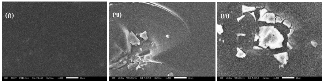
รูปที่ 2 ลักษณะพื้นผิวของฟิล์มบางไทเทเนียมไดออกไซด์บนกระจกที่อัตราเร็วการจุ่มเคลือบ (ก) 3, (ข) 9 และ (ค) 14 เซนติเมตรต่อนาที เมื่อวิเคราะห์ด้วยเครื่องจุลทรรศน์อิเล็กตรอนแบบส่องกราด
