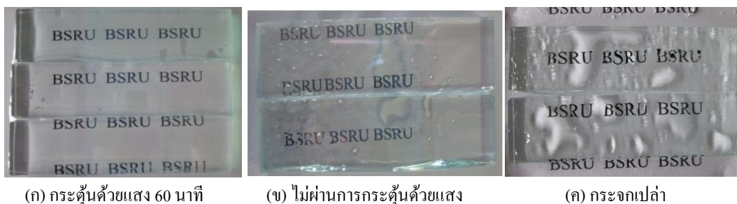
รูปที่ 8 ลักษณะหยดน้ำบนกระจกทำความสะอาดตัวเองและกระจกเปล่า
