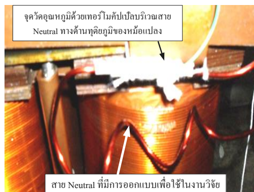
รูปที่ 8 ภาพจริงการติดตั้งเทอร์โมคัปเปิลที่ลวดตัวนำสายนิวทรัล
