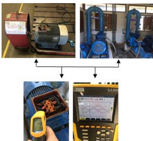
รูปที่ 7 ขั้นตอนการทดสอบ มอเตอร์ไฟฟ้า แบบไม่มีภาระโหลดและมีภาระโหลด
