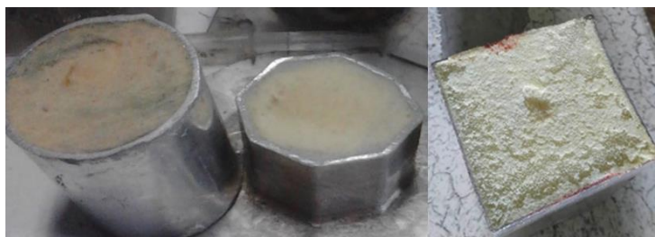
รูปที่ 4 ลักษณะของท่อรูปร่างพื้นที่หน้าตัดหลายเหลี่ยมเต็มโพม
