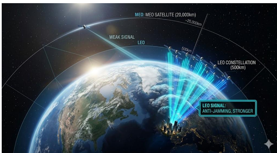
รูปที่ 4 การเปรียบเทียบเชิงยุทธศาสตร์ระหว่างระบบ LEO PNT และวงโคจรระดับกลาง (MEO) แหล่งที่มา: ผู้วิจัยดัดแปลงจาก [22]
