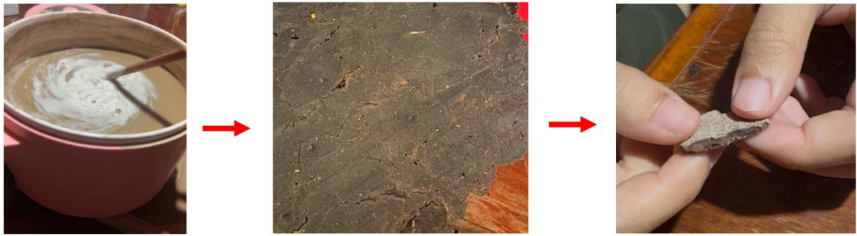
รูปที่ 2 ขั้นตอนการผลิตแผ่นสมาร์ทบอร์ด (ก) ผสมส่วนประกอบและคนให้เข้ากัน (ข) เทส่วนผสมลงแม่พิมพ์ (ค) แผ่นสมาร์ทบอร์ดจากต้นกล้วย
