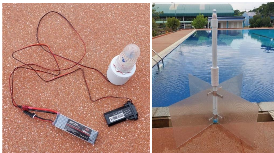
รูปที่ 3 (ซ้าย) แสดงส่วนประกอบต่าง ๆ ที่จะถูกนำไปติดตั้งบนทุ่นลอย ได้แก่ (1) ตัวรับสัญญาณจีพีเอส (2) แบตเตอรี่ และ (3) ไฟสัญญาณ (ขวา) แสดงลักษณะทุ่นลอยที่เสร็จสมบูรณ์พร้อมใช้งาน
