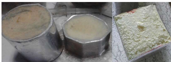
รูปที่ 4 ลักษณะของท่อรูปร่างพื้นที่หน้าตัดหลายเหลี่ยมเติมโฟม
