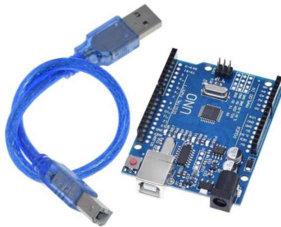
รูปที่ 4 บอร์ด Arduino Uno R3 แบบ Open-source ชิป ATmega328
