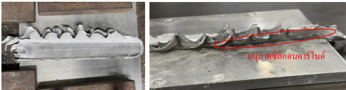
รูปที่ 4 ลักษณะแนวเชื่อมด้านบนและด้านข้างที่ผ่านการเชื่อมหัวทวนสี่เหลี่ยม 2 รอบ
