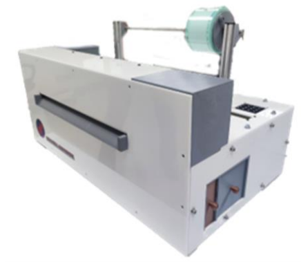
รูปที่ 2 เครื่องตัดถุงสโตโรอัติโนมติต้นแบบ
