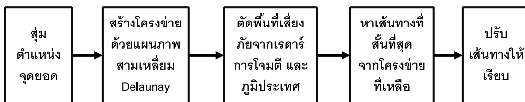
รูปที่ 3 ขั้นตอนในการประยุกต์ใช้แผนภาพสามเหลี่ยม Delaunay ในการหาเส้นทางที่เหมาะสมต่อการบินปฏิบัติการกิจในพื้นที่สามมิติ
