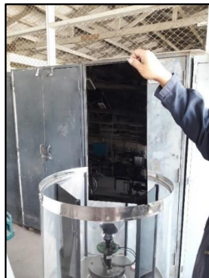
รูปที่ 7 การปิดแผ่นเลนส์ (Blanking) ของต้นแบบตะเกียงระบบเลนส์หมุน ๆ
