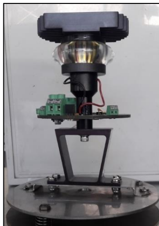
รูปที่ 4 เครื่องแสงสว่าง LED (LED Light Source) ของต้นแบบตะเกียงระบบเลนส์หมุน ๆ โดยในรูปใช้หลอดไฟ LED ขนาด 20 W [4]
