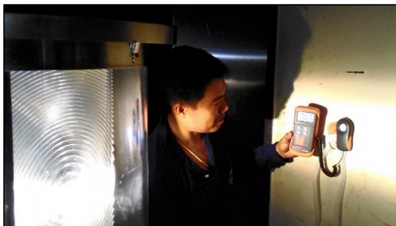
รูปที่ 10 การตรวจวัดความเข้มของการส่องสว่างของต้นแบบตะเกียงระบบเลนส์หมุน ฯ โดยใช้เครื่องวัดแสงระบบดิจิทัล [4]
