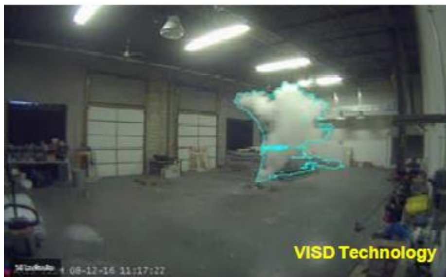
รูปที่ 2 อุปกรณ์ตรวจจับควันแสดงภาพวิดีโอ (Video Image Smoke Detection, VISD) [3]
