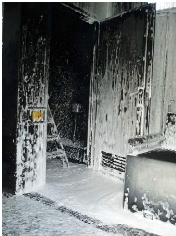
รูปที่ 7 แสดงการใช้ CAFS กับโฟมชนิดขยายตัวสูง AR-AFFF ดับไฟประเภท ข (Class B) ในเรือฝึกจำลองที่แผนกอุปกรณ์ดับเพลิง กองการฝึกกองเรือยุทธการ อ.สัตหีบ จ.ชลบุรี (ภาพถ่ายปี พ.ศ.2562)
