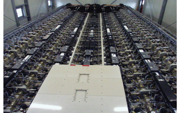
รูปที่ 3 แบตเตอรี่ในห้องเก็บแบตเตอรี่ของเรือดำน้ำ
