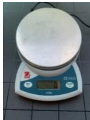
รูปที่ 1 เครื่องชั่งน้ำหนักแบบดิจิตอล รุ่น CS 2000 ยี่ห้อ OHAUS
