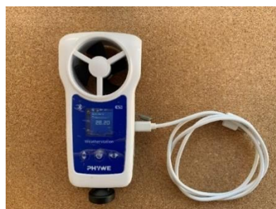
รูปที่ 5 เครื่องวัด Weatherstation ยี่ห้อ PHYWE ใช้สำหรับวัดอุณหภูมิ ความชื้นสัมพัทธ์และความเข้มแสง
