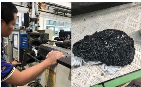
รูปที่ 5 ของเสียจากการไล่กระบอกพลาสติกทั่วไป
