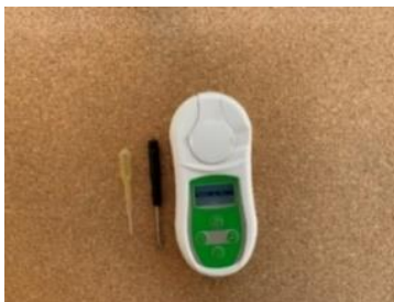
รูปที่ 3 เครื่องวัดความหวาน (Brix) แบบดิจิตอลแบบ Handheld Sugar Meter Model RF019 Measuring Range : Brix ช่วง 0.0–32.0%
