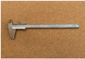
รูปที่ 2 เครื่องวัดความยาวอย่างละเอียดเวอร์เนียร์ แคลิเปอร์ ยี่ห้อ Mitutoyo ความละเอียด 0.05 มิลลิเมตร
