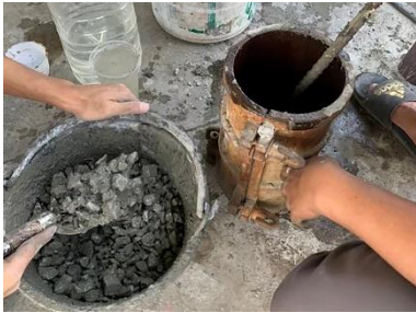
รูปที่ 9 การหล่อคอนกรีตตัวอย่างรูปทรงกระบอก
