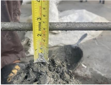
รูปที่ 8 ทดสอบหาค่ายุบตัวของคอนกรีต
