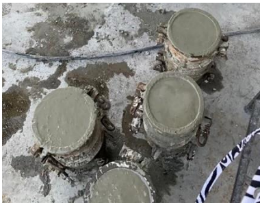
รูปที่ 10 ปาดผิวหน้าของคอนกรีต
