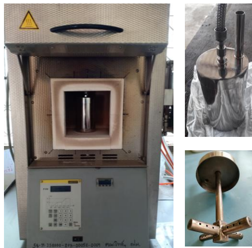
รูปที่ 2 เตาเผาและชุดปฏิกรณ์ในกระบวนการทอรีแฟกชัน
