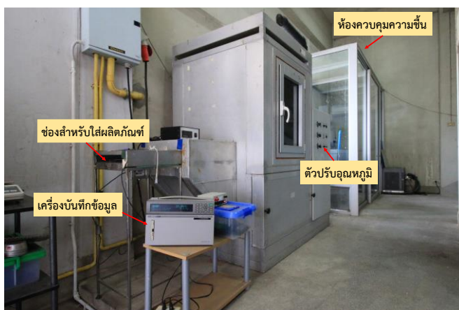
รูปที่ 2 ลักษณะของเครื่องอบแห้งแบบชั้นบาง (laboratory dryer) ห้องปฏิบัติการพลังงานแสงอาทิตย์ ภาควิชาฟิสิกส์ มหาวิทยาลัยศิลปากร
