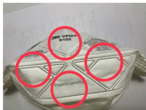
รูปที่ 7 ตัวอย่างหน้ากาก N95 รุ่น VFLEX 9105 ของบริษัท 3M และตำแหน่งการตัดชิ้นงานส่งทดสอบ
