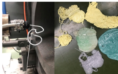
รูปที่ 6 ของเสียจากการไล่กระบอกพลาสติกสีใส
