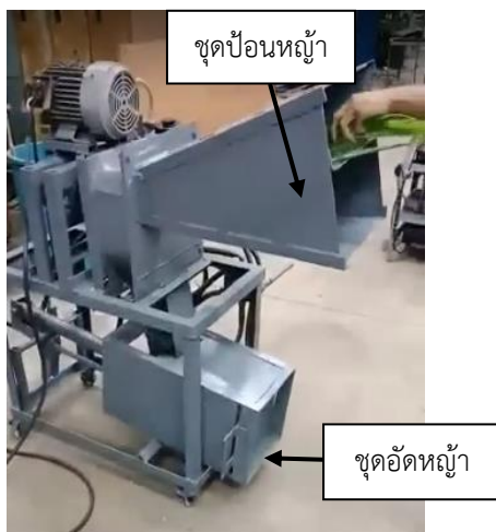
(2) เครื่องต้นแบบเครื่องย่อยและอัดหญ้าอาหารสัตว์ รูปที่ 7 แบบและเครื่องต้นแบบเครื่องย่อยและอัดหญ้าอาหารสัตว์
