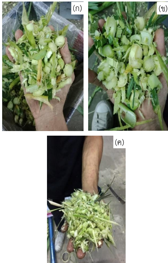
รูปที่ 11 หย้าที่ถูกสับย่อยที่มุมองศาของใบมีด 15 30 และ 40 องศา (ก) ลักษณะหย้าที่ย่อยได้ที่มุมคมใบมีด 15 องศา (ข) ลักษณะหย้าที่ย่อยได้ที่มุมคมใบมีด 30 องศา (ค) ลักษณะหย้าที่ย่อยได้ที่มุมคมใบมีด 40 องศา
