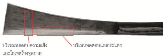
รูปที่ 3 บริเวณที่ใช้ทดสอบความแข็ง ความต้านทานแรงกระแทก และตรวจสอบโครงสร้างจุลภาค
