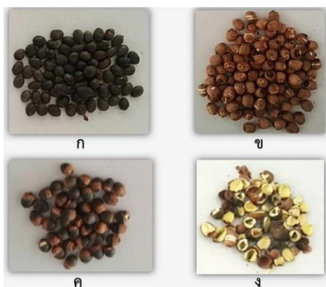
รูปที่ 5 ก) เมล็ดบัวหลวงที่ใช้ทดสอบ ข) เมล็ดบัวหลวงหลังการแกะเปลือก ค) เมล็ดบัวที่แกะเปลือกไม่หมด และ ง) เมล็ดบัวที่เสียหายจากการทดสอบ
