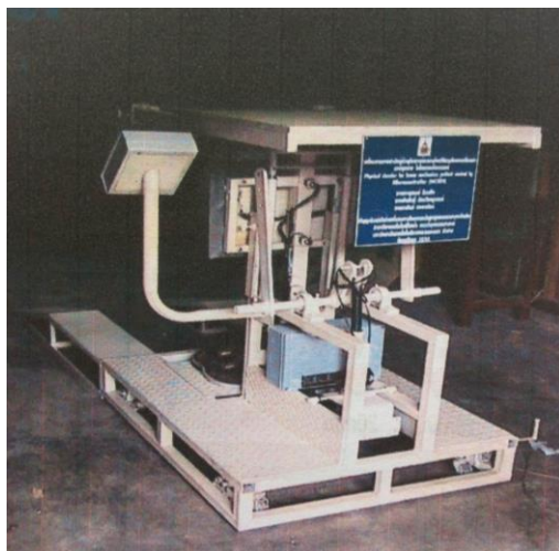
รูปที่ 3 เครื่องกายภาพบำบัดผู้ป่วยอัมพาตท่อนล่าง ด้วยวิธีการช่วยยืนและเคลื่อนเท้าควบคุมด้วย ไมโครคอนโทรลเลอร์
