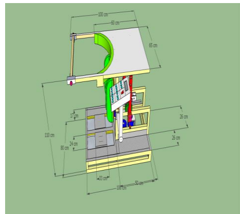
รูปที่ 1 โครงสร้างของเครื่องกายภาพบำบัดผู้ป่วยอัมพาตท่อนล่างด้วยวิธีการช่วยยืนและเคลื่อนไหวเท้าควบคุมด้วยไมโครคอนโทรลเลอร์
