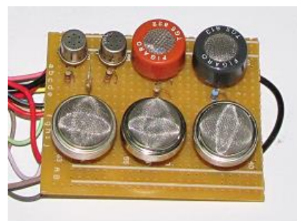
รูปที่ 3 แก๊สเซ็นเซอร์ต่อรวมกันเป็นจุ่มกิโลอิเล็กทรอนิกส์
