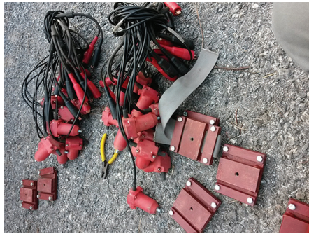
รูปที่ 5 อุปกรณ์รับสัญญาณคลื่น (Geophone)
