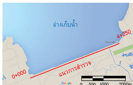
รูปที่ 4 แนวการสำรวจตลอดความยาวของสันเขื่อนเป็นระยะทาง 4,250 เมตร
