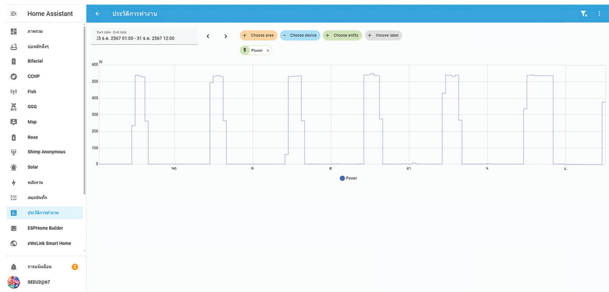
(ง) ผลการตรวจวัดกำลังไฟฟ้าของปั้มน้ำร้อนที่ 1
