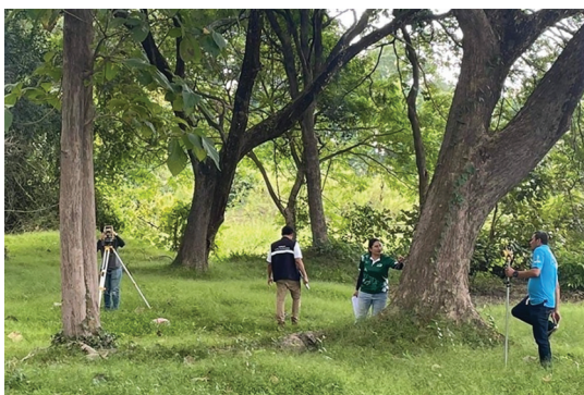
รูปที่ 3 การวัด โดยการส่องกล้อง Total Station ไปยังปริซึม
