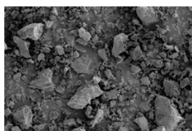
(ก) ปูนซีเมนต์ GU กำลังขยาย 1,000 เท่า (ข) ปูนซีเมนต์ PC กำลังขยาย 1,000 เท่า (ค) เถ้าลอยไม้ยางพารา RWA กำลังขยาย 1,000 เท่า รูปที่ 3 ลักษณะอนุภาคของวัสดุประสานโดยภาพถ่ายขยายกำลังสูง (SEM)
