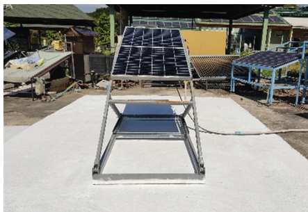
(ก) การติดตั้งแผงเซลล์แสงอาทิตย์ด้านหน้า (ข) การติดตั้งแผงเซลล์แสงอาทิตย์ด้านหลัง รูปที่ 1 การติดตั้งแผงเซลล์แสงอาทิตย์แบบรับแสงสองด้าน (Bifacial PV)
