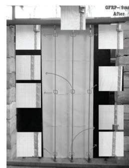
(ก) วัสดุ GFRP ขนาด 9 มิลลิเมตร ก่อนดึง (ข) วัสดุ GFRP ขนาด 9 มิลลิเมตร หลังดึง รูปที่ 11 การเปรียบเทียบพฤติกรรมก่อนและหลังให้แรงดึงขนาด 30 ปอนด์ ในวัสดุ GFRP ขนาด 9 มิลลิเมตร
