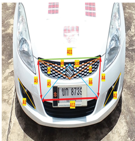
(ก) การวัดขนาดบนรถยนต์ที่ไม่ได้รับความเสียหาย (ข) การวัดขนาดบนรถยนต์ในแบบจำลองรูปที่ 6 ตำแหน่งการวัดระยะจริงและภาพขาวแสดงการวัดระยะจากโมเดลสามมิติ
