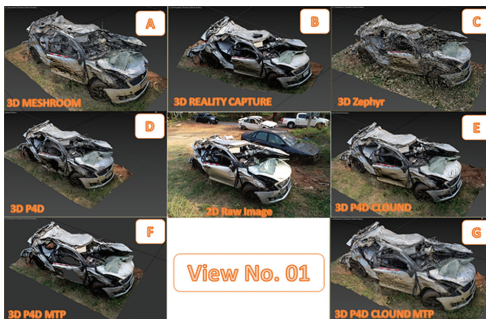
รูปที่ 5 การประมวลผลด้วยโปรแกรมแบบต่าง ๆ และการประเมินความครบถ้วนของแบบจำลองสามมิติ
