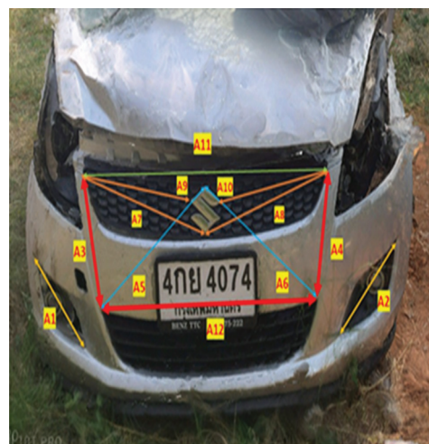
(ก) การวัดขนาดบนรถยนต์ที่ไม่ได้รับความเสียหาย (ข) การวัดขนาดบนรถยนต์ในแบบจำลองรูปที่ 6 ตำแหน่งการวัดระยะจริงและภาพขาวแสดงการวัดระยะจากโมเดลสามมิติ
