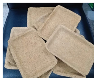
รูปที่ 2 ตัวอย่างโฟมชีวภาพต้นแบบจากเส้นใยจากกล้วยและแป้งมันสำปะหลัง (พันธุ์ 81) ที่เคลือบด้วยไข
