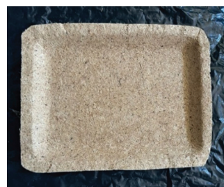
รูปที่ 2 ตัวอย่างโฟมชีวภาพต้นแบบจากเส้นใยจากกล้วยและแป้งมันสำปะหลัง (พันธุ์ 81) ที่เคลือบด้วยไข
