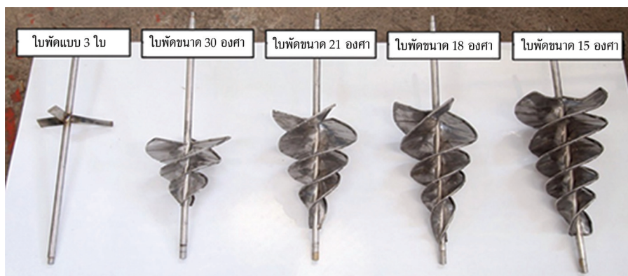
รูปที่ 3 โมเดลกังหันที่นำมาทดสอบ
