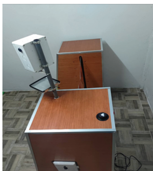
(ก) ด้านบนของประตู (ข) ด้านหลังของประตู (ค) ตัวอย่างการใช้งาน รูปที่ 5 ประตูอัจฉริยะเพื่อคัดกรองบุคคลด้วยระบบอัตโนมัติ (ต่อ)
