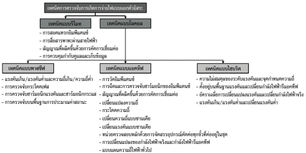
รูปที่ 1 สรุปเทคนิคการตรวจจับการแยกตัวอิสระ
