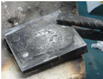
(ก) ลักษณะชิ้นงานที่ได้จากการขึ้นรูป (ข) โครงสร้างเกรนแบบก้อนกลม รูปที่ 1 โลหะผสมอะลูมิเนียมเกรด 2024 ที่ผ่านการขึ้นรูปด้วยเทคนิค GISS
