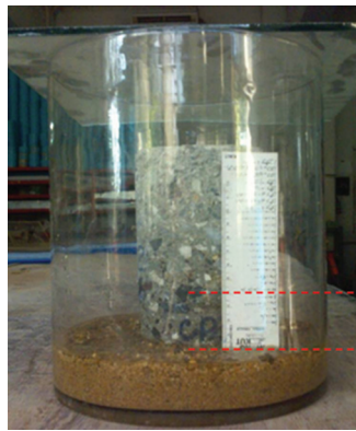
รูปที่ 10 การทดสอบการยกตัวของน้ำเนื่องจากแรงดึงผิวน้ำในคอนกรีต (CTB)
