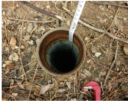
รูปที่ 6 การวัดระดับน้ำใต้ดินด้วยเทปวัดระยะ
