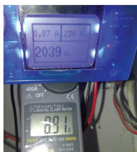
รูปที่ 12 เปรียบเทียบค่าจากแคลมป์มิเตอร์กับเครื่องต้นแบบ
