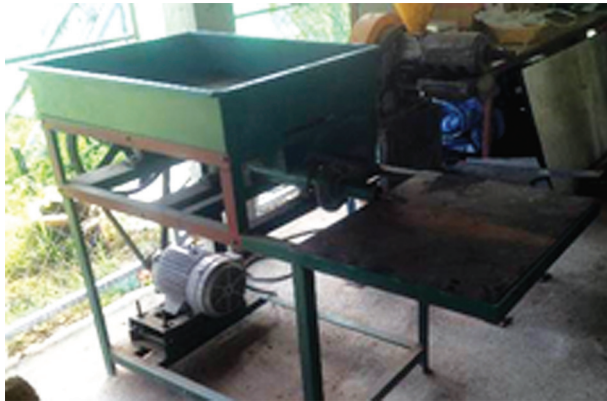
รูปที่ 3 เครื่องแวนอนแบบเกลียวทหมุน (อนุเคราะห์เครื่องมือโดย ศูนย์วิจัยพลังงาน มหาวิทยาลัยแม่โจ้)
