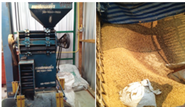
รูปที่ 1 เครื่องกะเทาะเปลือกสารกาแฟและชีวมวลเหลือทิ้งของกลุ่มวิสาหกิจชุมชนกาแฟสดแม่ต๋อน
