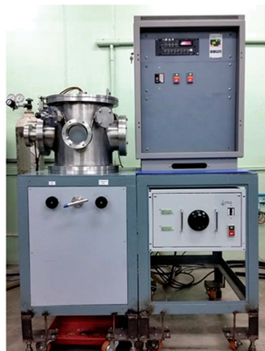
รูปที่ 1 ไดอะแกรมและลักษณะของเครื่องเคลือบในสุญญากาศที่ใช้ในงานวิจัย
