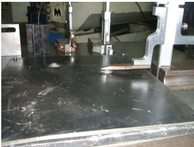
รูปที่ 16 วัดด้านหลังรอยยุบตัวแผ่นโลหะชุดที่ 3 ด้วย Vernier Height Gauges
