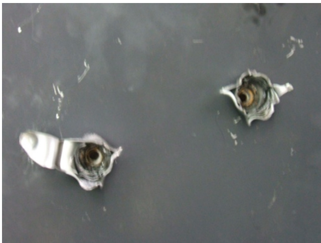
รูปที่ 17 ลักษณะการเจาะทะลุเป้าแผ่นเกราะที่ไม่ได้มาตรฐานของกระสุนปืนเอ็ม 16
