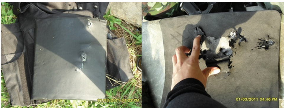
รูปที่ 1 เสื้อเกราะที่คุณภาพต่ำกว่ามาตรฐาน
