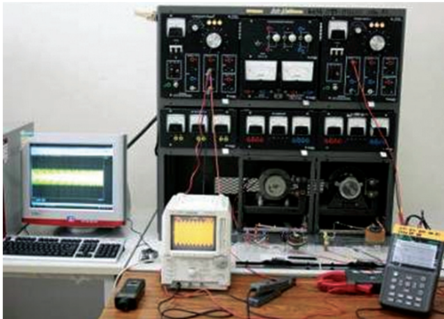
รูปที่ 5 การตรวจสอบสัญญาณกระแสเตเตอร์กรณีตัวนำโรเตอร์แตก
