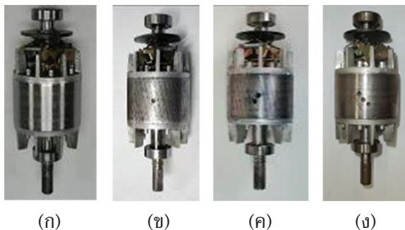
รูปที่ 6 โรเตอร์ที่ใช้ในการทดลองกรณีตัวนำโรเตอร์แตก (ก) HT (ข) 1BB (ค) 2BB (ง) 3BB
