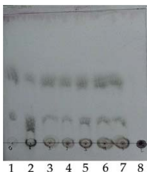
รูปที่ 2 การทดสอบ Oligosaccharides ด้วยวิธี Thin Layer Chromatography (TLC)
