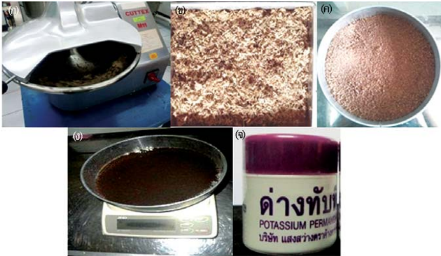
รูปที่ 2 วัสดุในการทำถาดรองผลไม้ (ก) เครื่องสับผสม (ข) เยื่อผักตบชวา (ค) ขุยมะพร้าว (ง) กากกาแฟ (จ) ต่างทับทิม
