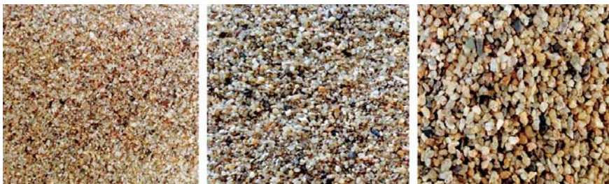
รูปที่ 4 ลักษณะของทรายที่นำมาใช้เป็นตัวกลางกรอง (ก) ขนาด 0.300 - 0.600 มิลลิเมตร (ข) ขนาด 0.600 - 1.160 มิลลิเมตร (ค) ขนาด 1.160 - 2.360 มิลลิเมตร
