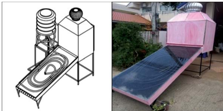
รูปที่ 2 การออกแบบและสร้างเครื่องอบแห้งสมุนไพรพลังงานแสงอาทิตย์
