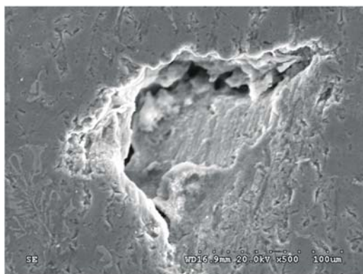
รูปที่ 7 ลักษณะตำแหน่งที่ซิลิคอนคาร์ไบด์หลุดออกจากเนื้อพื้นอะลูมิเนียม
