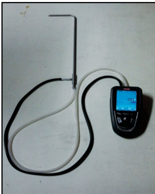
รูปที่ 3 เครื่องวัดความดันแบบ Pitot tube
