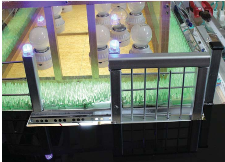
รูปที่ 10 ทดสอบเปิด - ปิด ประตูบานเลื่อน
